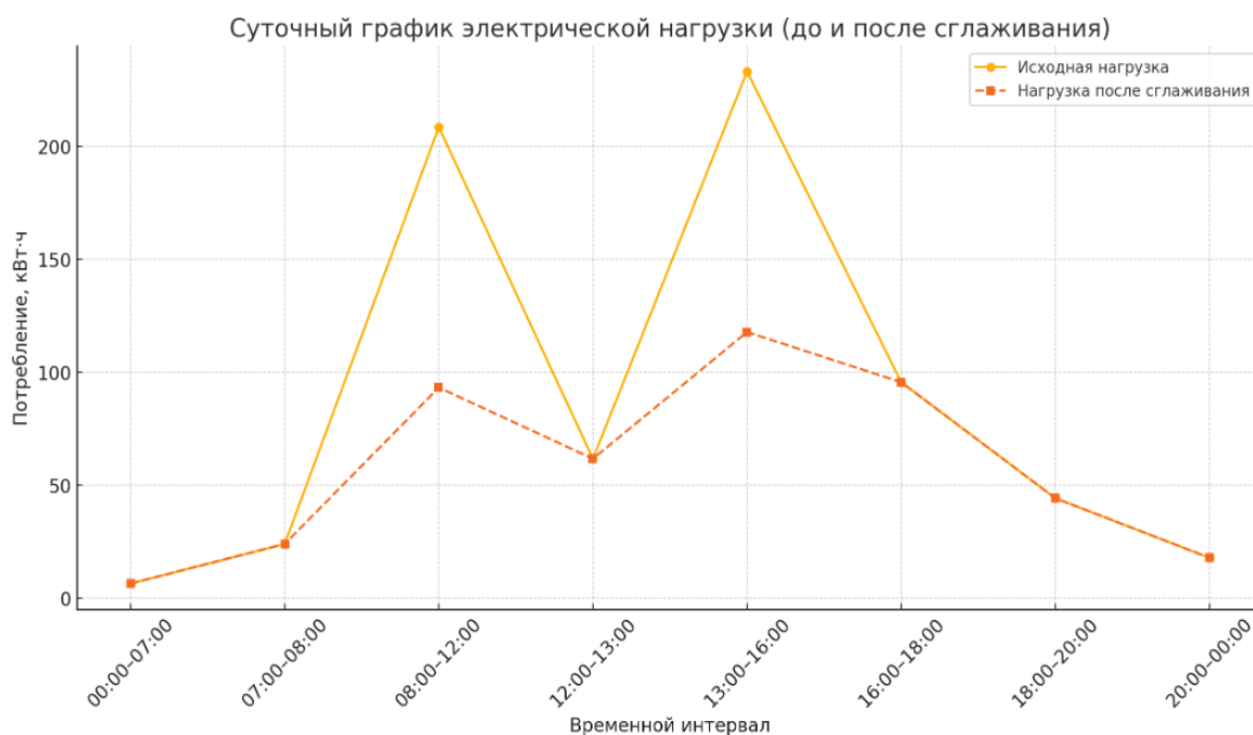
Рисунок 16 – График суточной нагрузки со сглаживанием пиков нагрузки
